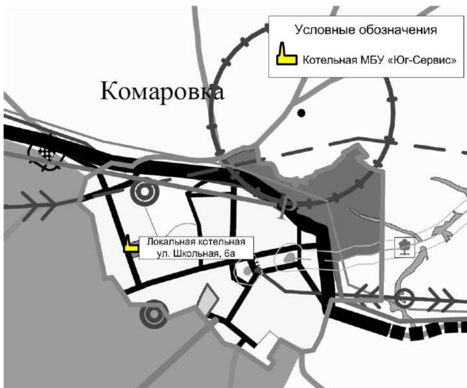
Рисунок 1.12.5.2 - Источники тепловой энергии с. Комаровка
