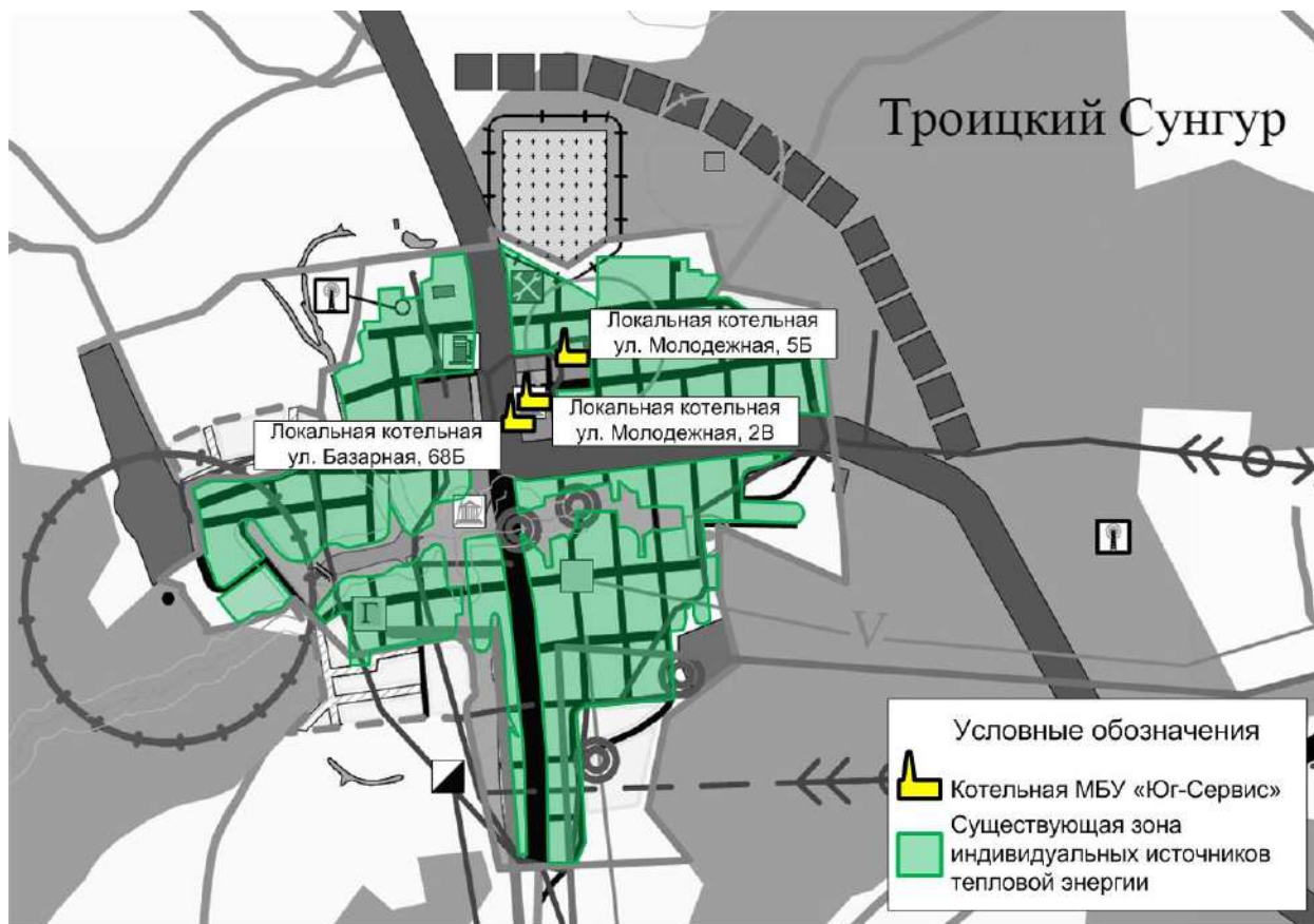
Рисунок 1.4.1 – Зоны действия локальных котельных и индивидуальных источников тепловой энергии, находящихся в частной собственности жителей, с. Троицкий Сунгур
